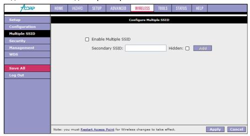
Включении дополнительных SSID (Enable Multiple SSID): Включает/ выключает поддержку дополнительных SSID на точке доступа.
