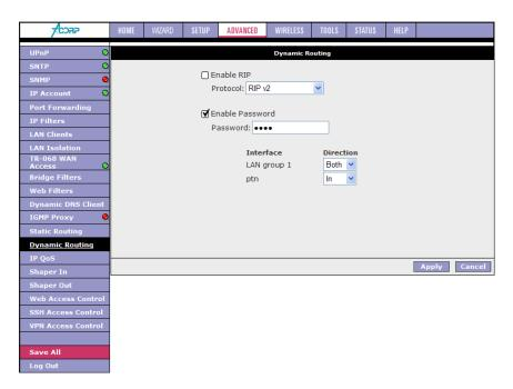
Включение (Enable RIP): Включение/ выключение маршрутизации по протоколу RIP. Протокол (Protocol): Выберите доступный протокол RIPv1, RIPv2 или RIPv1 совместимый.
